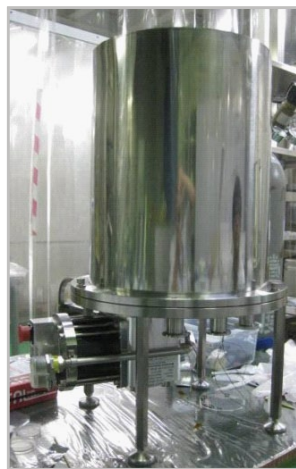
冷凍機冷却型超電導電磁石の外観
